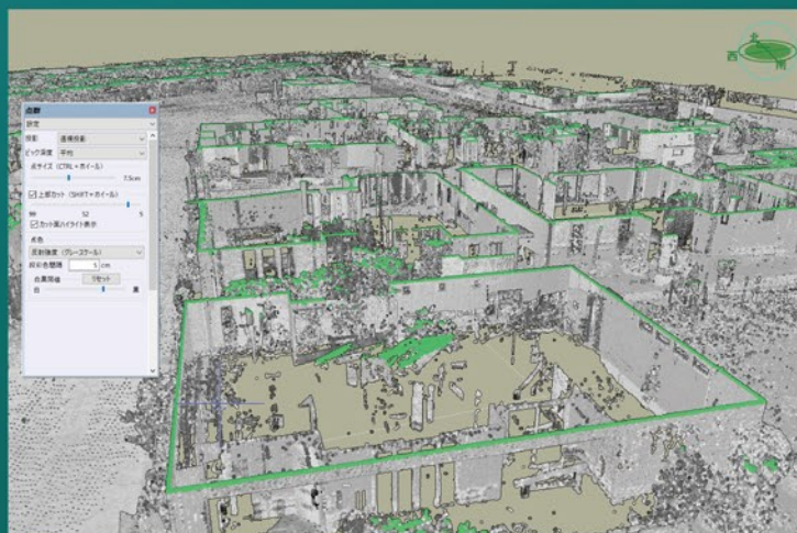
Shift+マウスホイールによる「上部カット」から建物形状の作成へ。形状のわかる位置を透視投影のまま最少の操作で見つけることができる。
