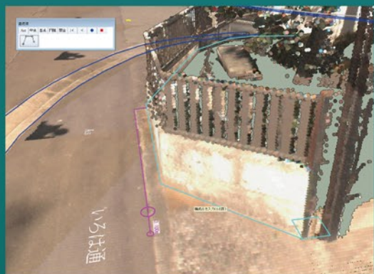
「線」コマンドと自動寸法ガイド。「標高ロック」併用で任意の標高にひたすら作図することも可能。
